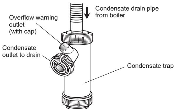
*Fig. 14 - Condensate trap*
